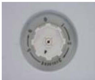
**Для минибара со сплошной дверцей,** внутренняя температура колеблется от 0С° до 10 С°. Вы можете повернуть ручку термостата для выбора нужной температуры. Поверните ручку, вращая по часовой стрелке в диапазоне шкалы от 1 до 6. Параметр шкалы «1» является максимальной температурой, а установка параметра «6» - минимальной температурой. Минибар будет выключен при установке термостата на значение «0».
